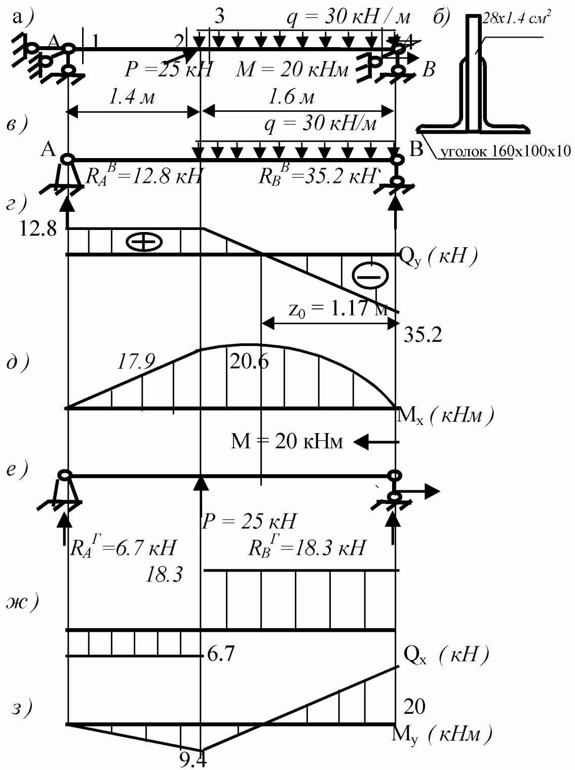
а - схема балки; б - поперечное сечение балки; в - схема сил, действующих на балку в вертикальной плоскости; г - эпюра поперечных сил  $Q_y$ ; д - эпюра  $M_x$ ; е - схема сил, действующих на балку в горизонтальной плоскости; ж - эпюра  $Q_x$ ; з - эпюра  $M_y$ .
