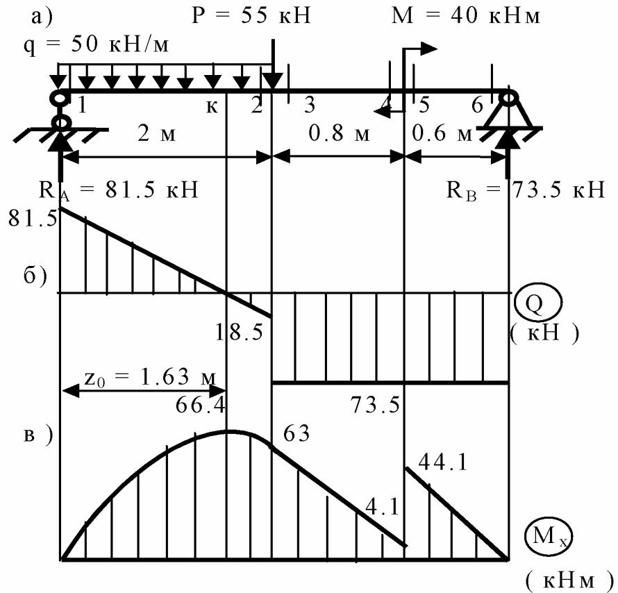
а – схема балки; б – эпюра поперечных сил;
