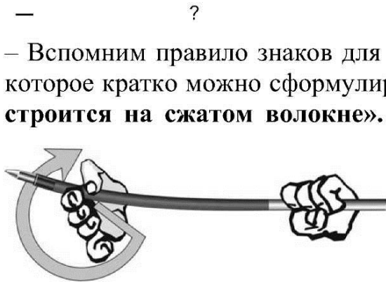
Рис.14. Простой опыт по определению положения сжатых волокон
