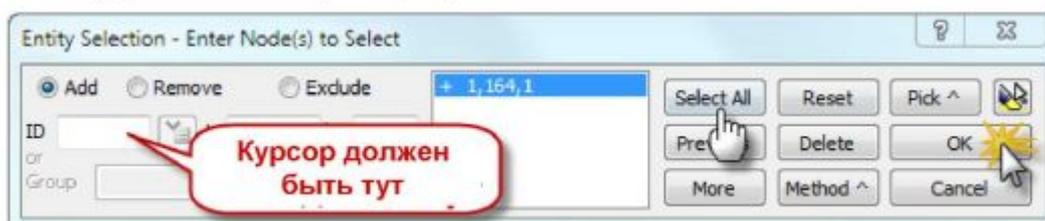
Выбираем все узлы и фиксируем перемещения по оси z (поле Tz) и повороты вокруг осей x и y (поля Rx та Rz).
