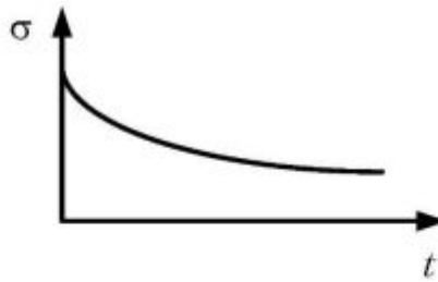
Рис. 17.4. Релаксация (уменьшение) напряжений в конструкции
