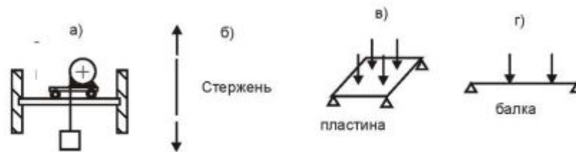
Рис. 1.1 Реальная объект и расчетная схема
