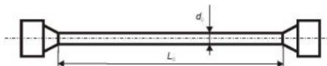
Рис. 5.1. Образец для испытаний на растяжение
