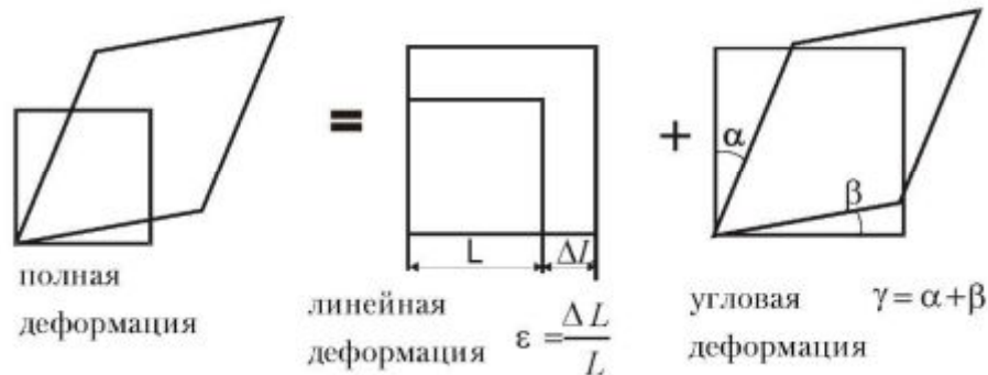
Рис. 1.7. Линейная и угловая деформация
