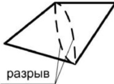
Рис. 23.2 Разрыв на границе элементов
