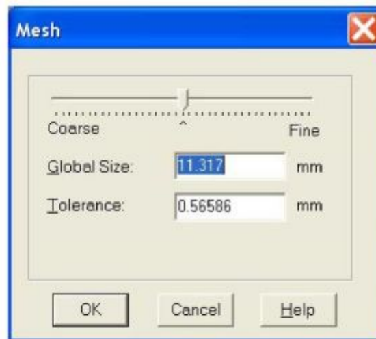
Рис. 26.22. Выбор размера конечных элементов
