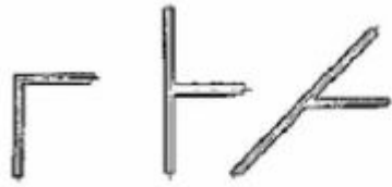
Рис. 46. Жесткое шарнирное соединение стержней
