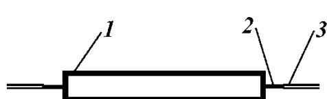
Рисунок 2.3 – Полупроводниковый тензорезистор
