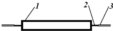
Рисунок 2.3 – Полупроводниковый тензорезистор
