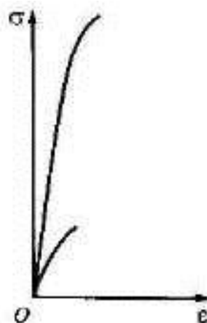
Рис. 1.8. Условные диаграммы растяжения материалов, находящихся в хрупком состоянии
